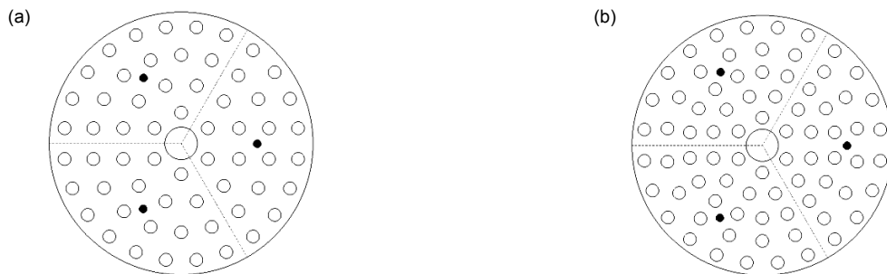
图 2 两种方案轴向支撑点布局示意图。(a) 60 点轴向支撑系统; (b) 78 点轴向支撑系统
