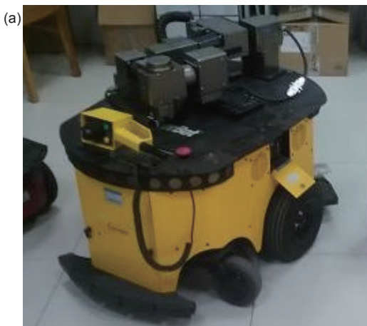
图 4 Powercube 机械臂与 Powerbot。(a) Powerbot; (b) Powercube
