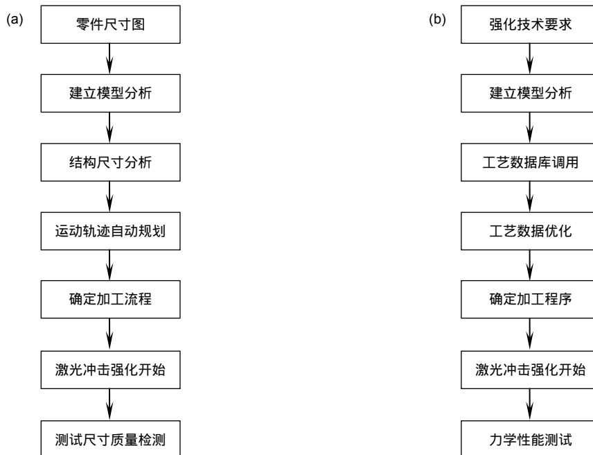
图 1 激光冲击强化控制系统的工作流程。(a) 激光冲击强化轨迹自动规划加工路线图。
