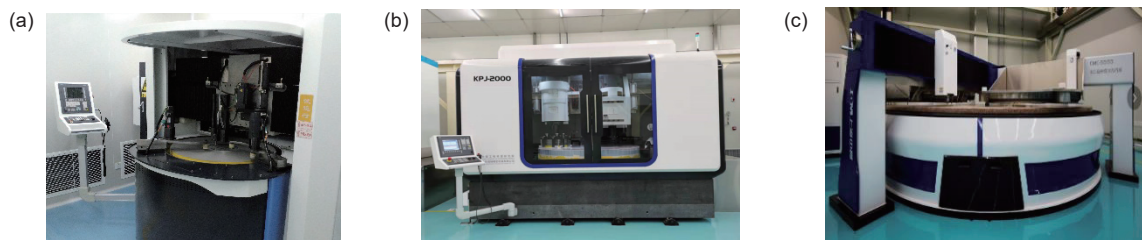
图 14 采用不同抛光盘类型的确定性全口径抛光机床。
