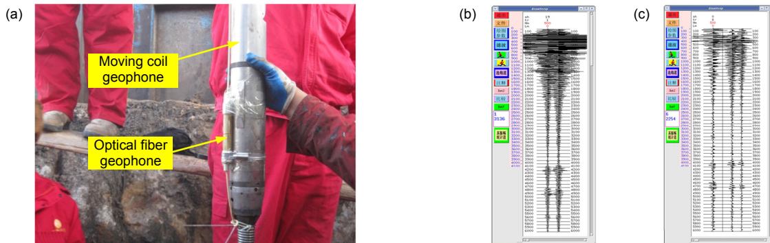
图 8 中国科学院半导体研究所的井下光纤激光检波器及其与 Sercel 动圈检波器的对比实验。(a)~(c)分别为动圈检波器和光纤检波器接收的放炮直达波和深层反射波信号 [49]
