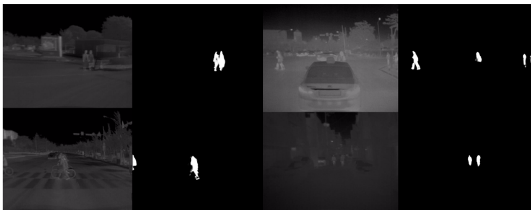
图 6 教师网络 R 3 Net 的部分显著性检测结果可视化。奇数列列为红外图像, 偶数列列为显著性检测结果
