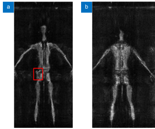
图 4 HM-SAR 安检图片。(a) 背面扫描的人体图片; (b) 正面扫描的人体图片
