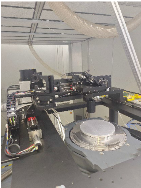
图 4 光束扫描台结构实物图
