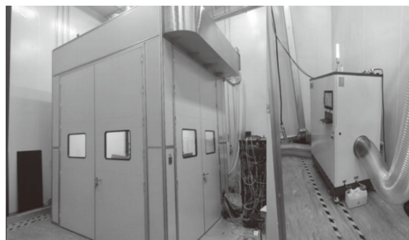
图 10 微环控系统恒温腔体及控制柜
