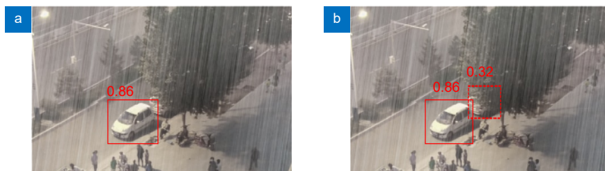
图 4 (a) NMS 与 (b) Soft NMS 检测效果对比示例图
