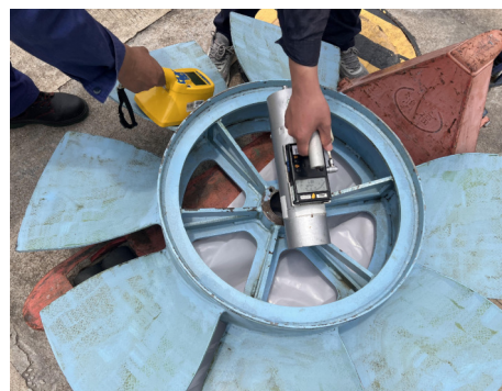
图 17 清洁解控电机叶轮
